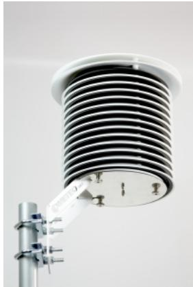
Professzionális passzív napsugárzás és időjárás elleni védelem a meteorológiai érzékelők, távadók és adatgyűjtők számára a jobb és a pontosabb mérés érdekében, természetes szellőzés mellett.
